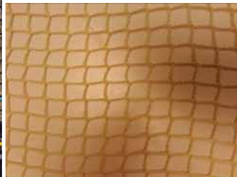
Figur 3. Ledekanal av Kevlar knuteløst nett (Rachel fletting) brukt om bord i G.O. Sars i mars 2015. Detaljert visning av nett til høyre.
