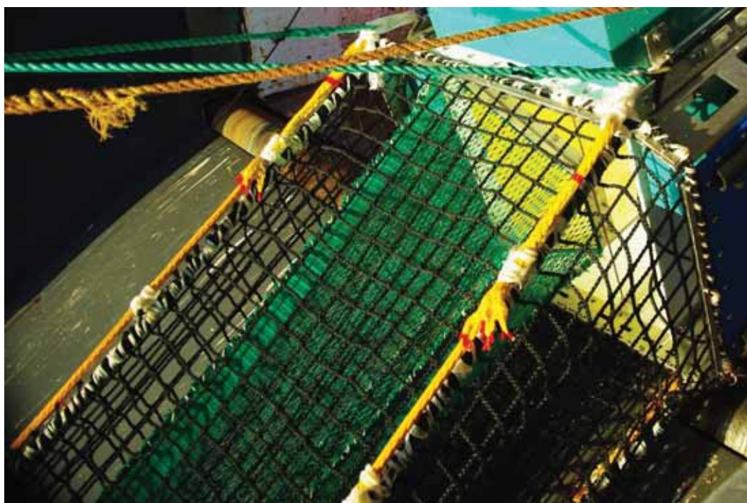
Figur 7. Konstruksjon av ledekanal bak Deep Vision (grønt diamantmasker)
