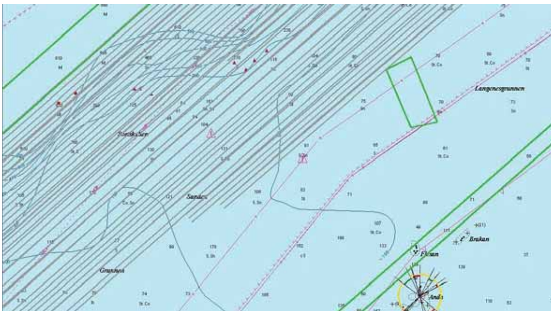
Figur 2.3. Plassering av hyselinene (grønt rektangel) i forhold til de seismiske kurslinjene (grå). Det ble ikke avfyrt luftkanonskudd direkte over linene.
