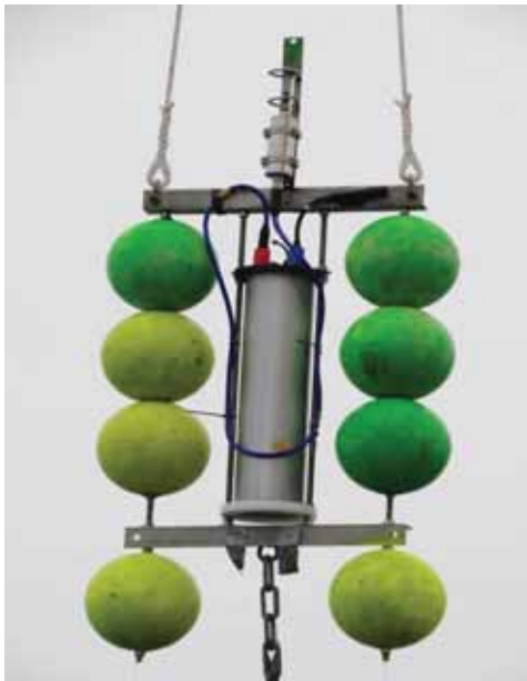
Figur 2.5. Hydrofonrigg for lydmåling ved bunnen. En akustisk utløser og et lodd i et 3 m langt tau henger under riggen.
