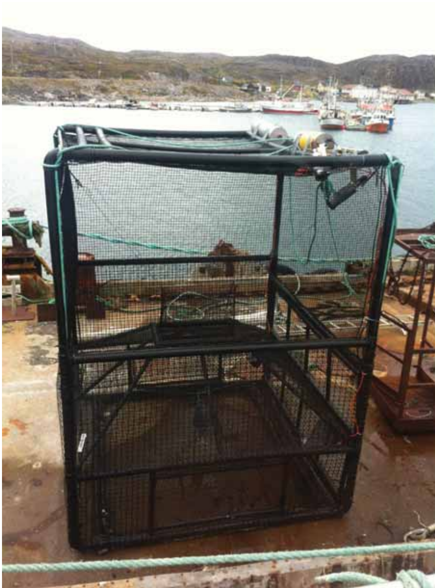
Figur 3. Teine bygget i plastrør påmontert videokameraer.
