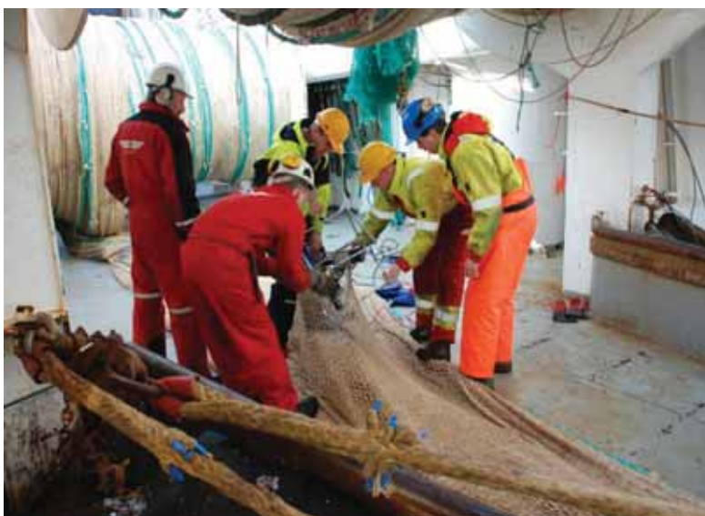
Figur 4. Montering av kamera-rigg ca ti meter foran overgangen mellom trålpose og forlengelse. M/S "Selvåg Senior".
