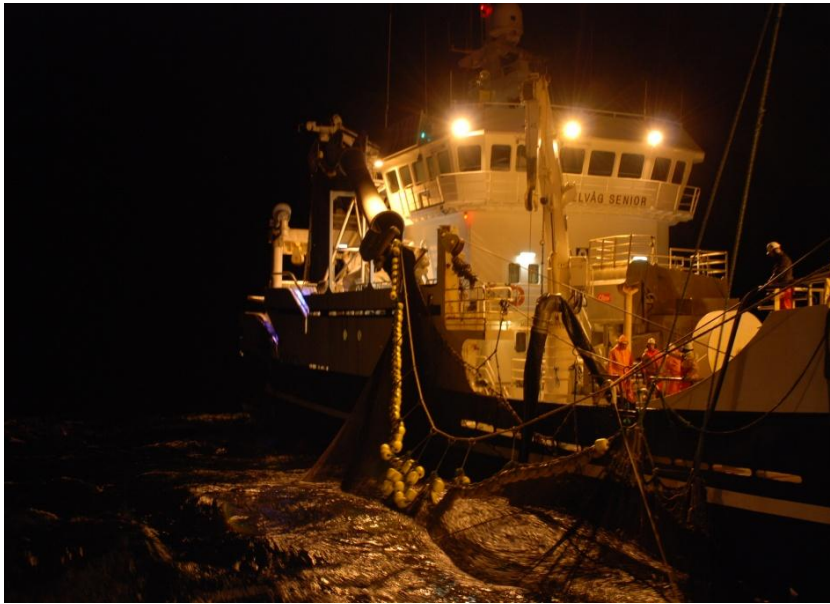
Bilde 5. Ordinær flåsnurpe hvor flåtelna henger i slakke bukter. Et ”skjørt” mellom telne og flåsnurpe ville effektivt hindret tap av fisk mellom flåtelna og flåsnurpa.
