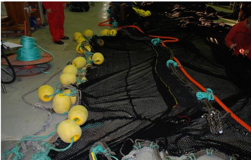
Bilde 4. Garnering med ny flåsnurpe (rød) montert i nota til M/S ”Sjarmør.
