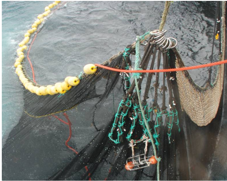
FIGUR 22. NOTBRYST RIGGET FOR SLIPPING MED GEILTAU I LANGE (1 M) HANEFØTTER.
