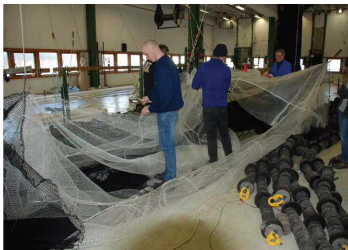
FIGUR 8. MONTERING AV "USYNLIG KISE" I NOT VED EGRSUND TRÅLVERKSTED.
