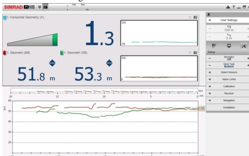
Figur 2.4.9. Skjerm bilde fra SIMRAD-PI-kabinett viser en avstand fra midten av head-line til babord vingespiss på 51.8 meter, mens avstand til styrbord vingespiss er 53.3. Det betyr at styrbord vinge ”går” foran babord vinge.
