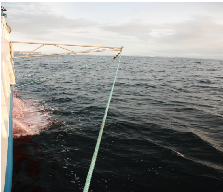
Figur 2.4.7. Utriggerbom for tauing av paravan og slepemikrofon for mottak av signaler fra PI redskapssensorer.
