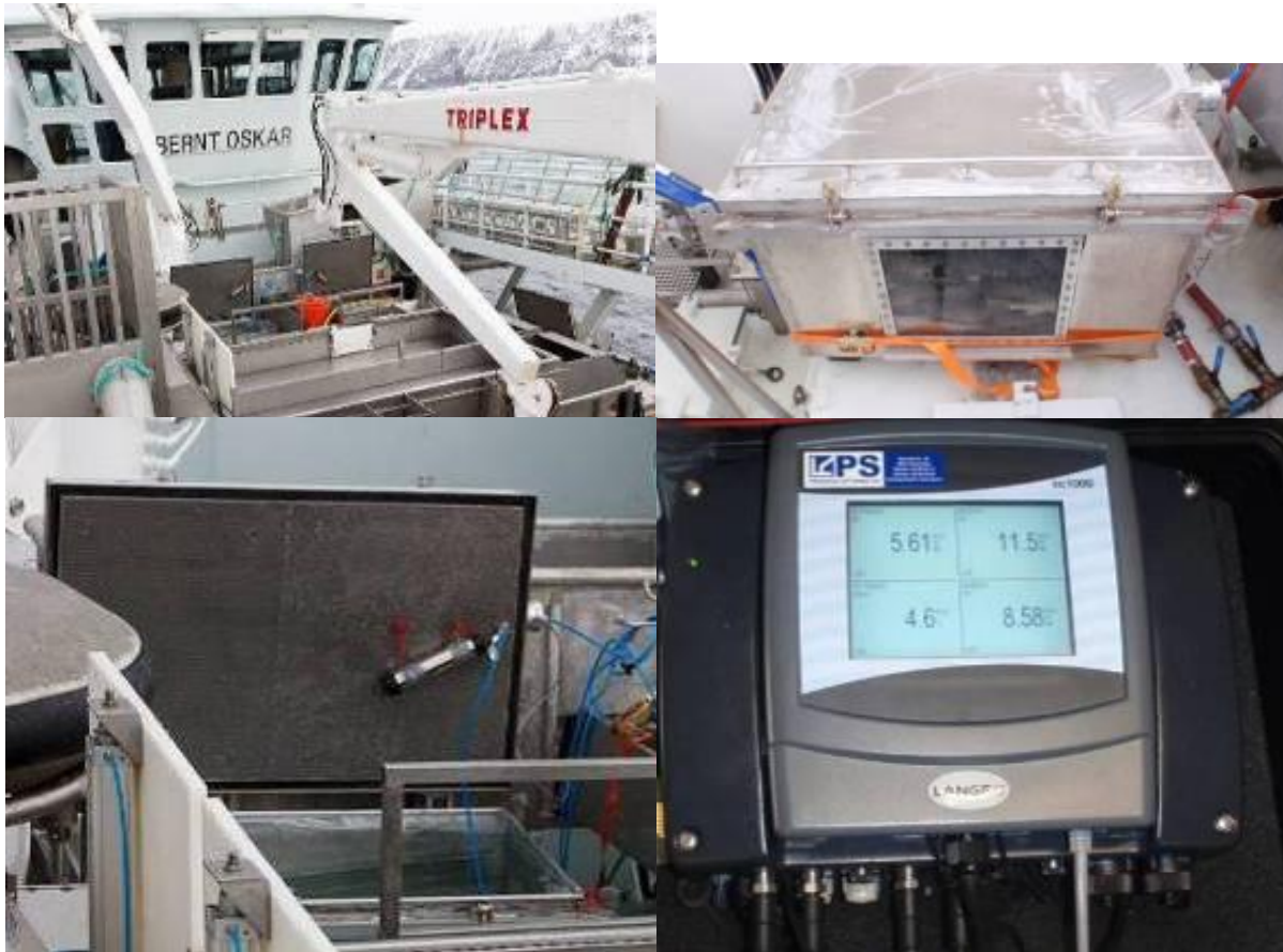
Figur 2.2.1. Oppe venstre: plassering av kar om bord på ”Bernt Oskar”; Oppe høyre: lukket kar med fisk, justering av vanngjennomstrømming; Nede venstre: plassering av oksygenmåler i lokk før avsilingsrist. Nede høyre: overvåking av oksygen og temperatur fra loggeenhet.
