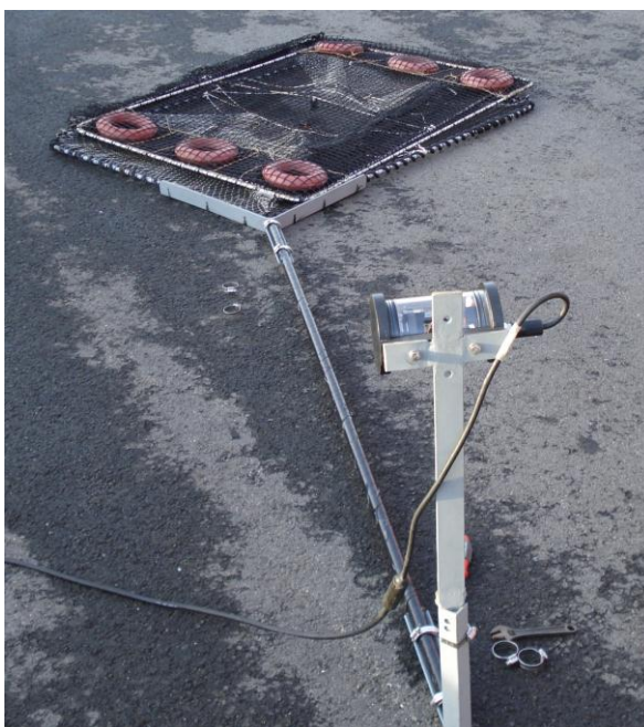
Fig. 6. Small pot with attached camera (photo: K. Bagdonas) 6 pav. Maža gaudyklė su pritaisyta kamera (nuotrauka autoriaus)
