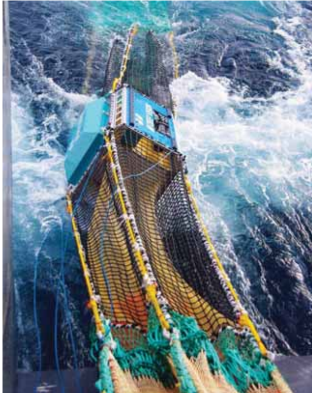
Figur 29. DeepVision er skjev før den skal opp trålslippen.
