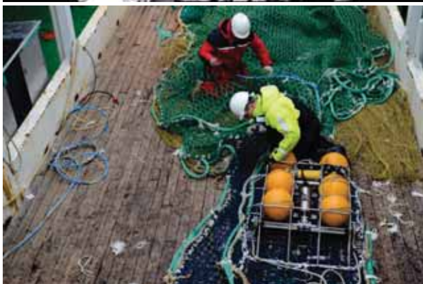
Figur 16. Montering av ramme for motor, batteri og kommunikasjons transponder i fall-lem systemet.
