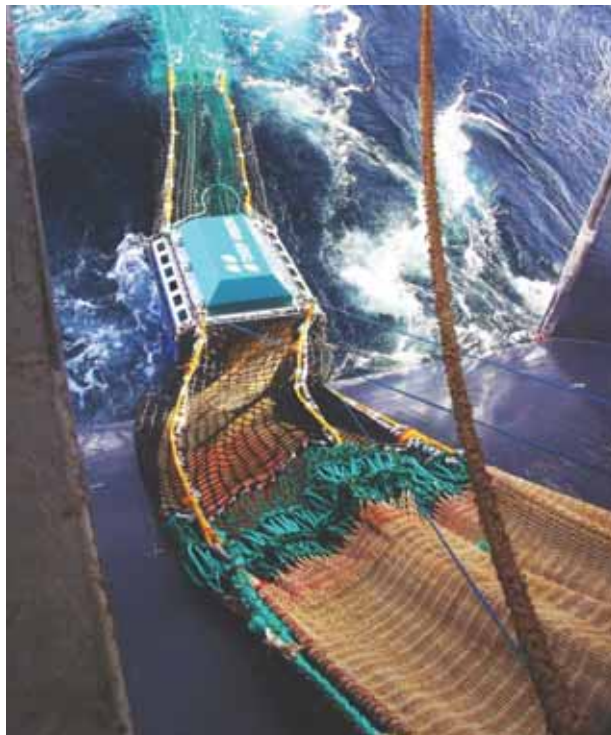
Figur 30. Deep Vision enheten er rettet opp ved hjelp av styretau før den trekkes opp trålslippen
