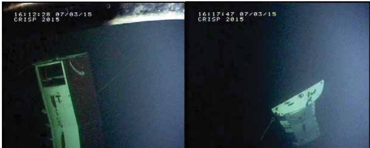
Figur 22. To bilder som viser 100 % lukking av luke på slutten av st 99 i løpet av ca 5 minutter
