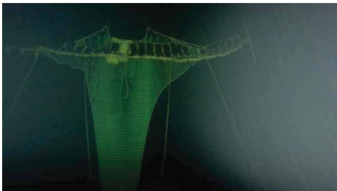
Figur 28. Løftekite på headlina satt ut av funksjon på grunn av framtrekk i sondekabelen.
