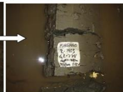
778 stor grabb, vertikalt snitt
