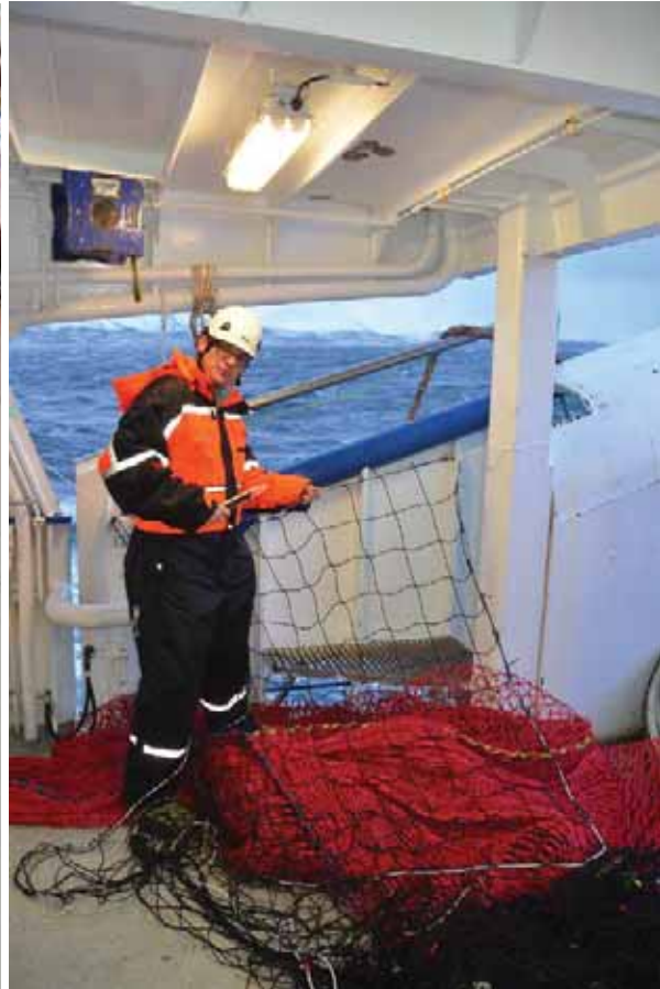
Bilde 8. Tokt med Fugløyhav, kvadratmaskepanel sydd inn
