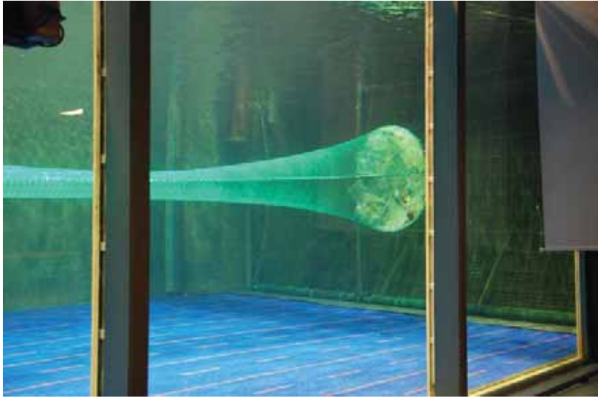
Bilde 2. Topanels pose montert i bakkant av spesialforlengelse for å gi strekk/drag i forlengelsen.
