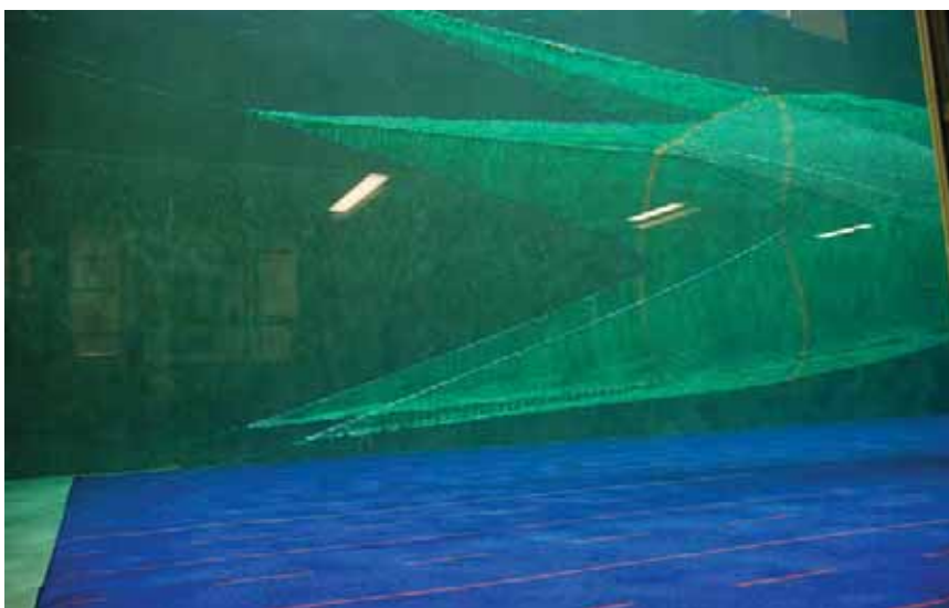
Figur 10. Fullskala modell av spesialforlengelse med lede- og skillepanel, her tegnet med vingespisser for montering av slepefester under forsøkene i flumetanken.
