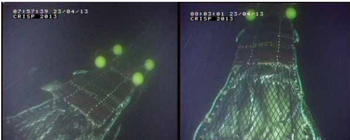
Figur 16. Fangstutslipp med gummimatte som er aktivisert av posen bakenfor er fylt opp av fisk.
