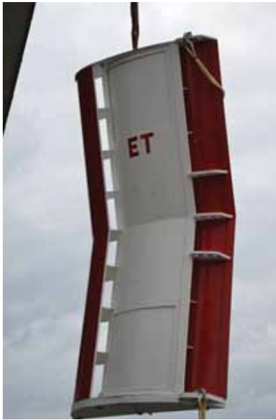
Figur 2. SeaFlex tråldører brukt i forsøkene.
