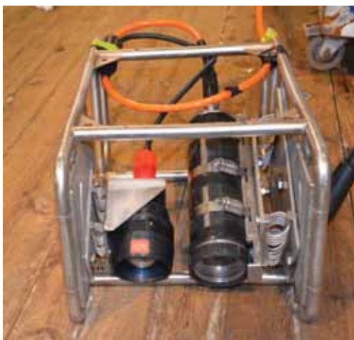
Figur 9. Kamera med lys for direkte overføring av video-signaler via sondekabel til fartøy.
