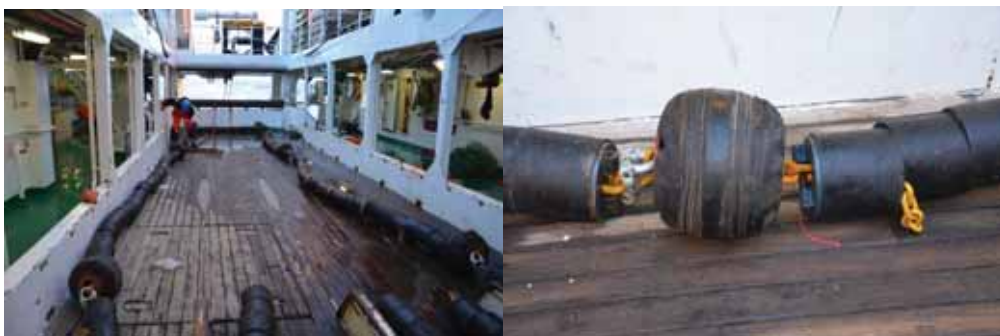
Figur 3. Gear med 8" fyllstykker og bobbinsjer mellom seksjoner på 6 m.
