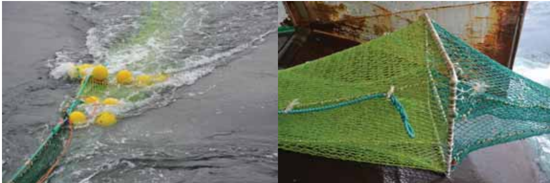
Figur 12. Arrangementet med rister for artseleksjon foran vertikaldelte poser festet til en ramme.
