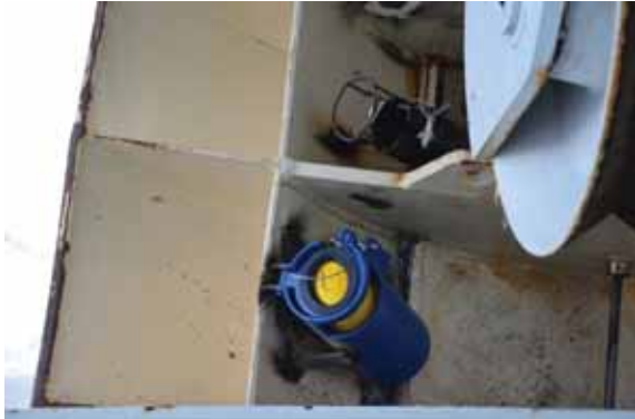
Figur 10. PX sensor for måling av avstand til bunn og rollvinkel montert under tauebrakett på pelagisk tråldør.
