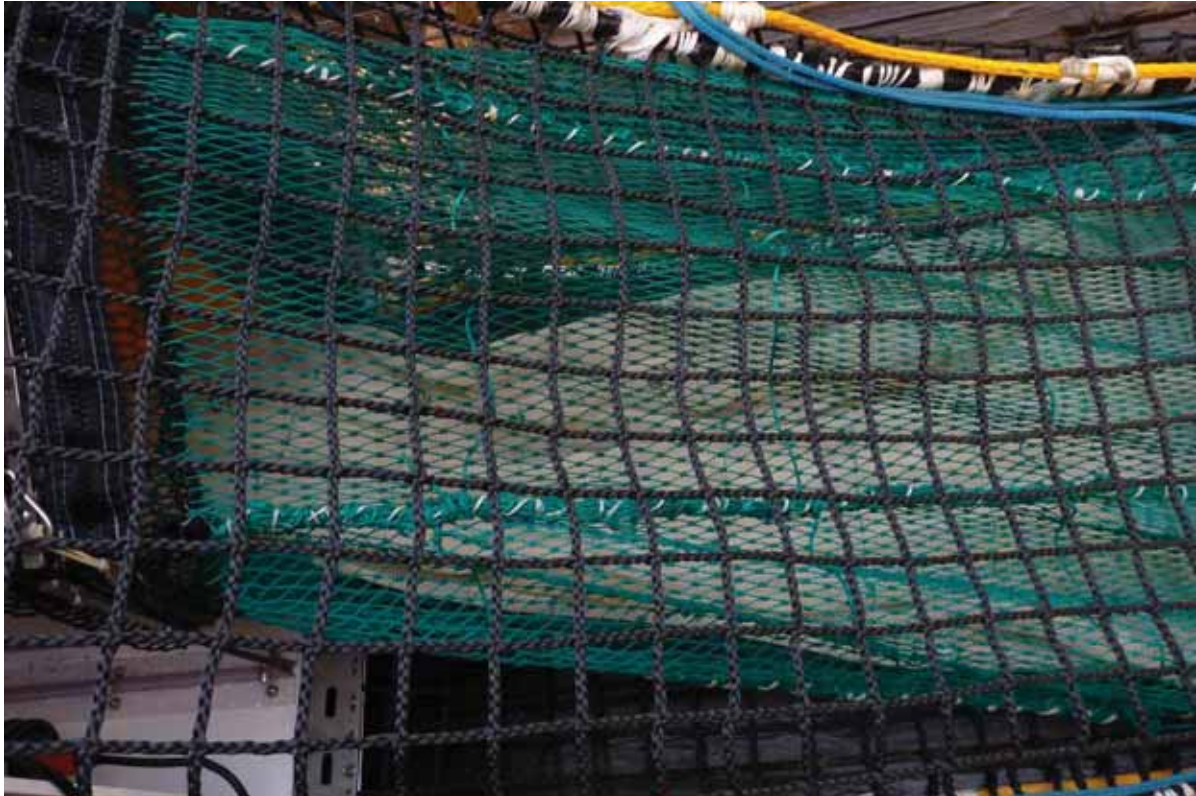
Figur 6. Ledekanal med 140 mm UC PE ytrenett (svart), 50 mm diamantmasker innernett (grønt) og 8 mm blaffrenett (Hvit).
