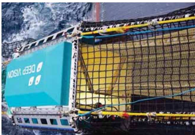
Figur 3. Ledekanal av Kevlar knuteløst nett (Rachel fletting) brukt om bord i G.O. Sars i mars 2015. Detaljert visning av nett til høyre.
