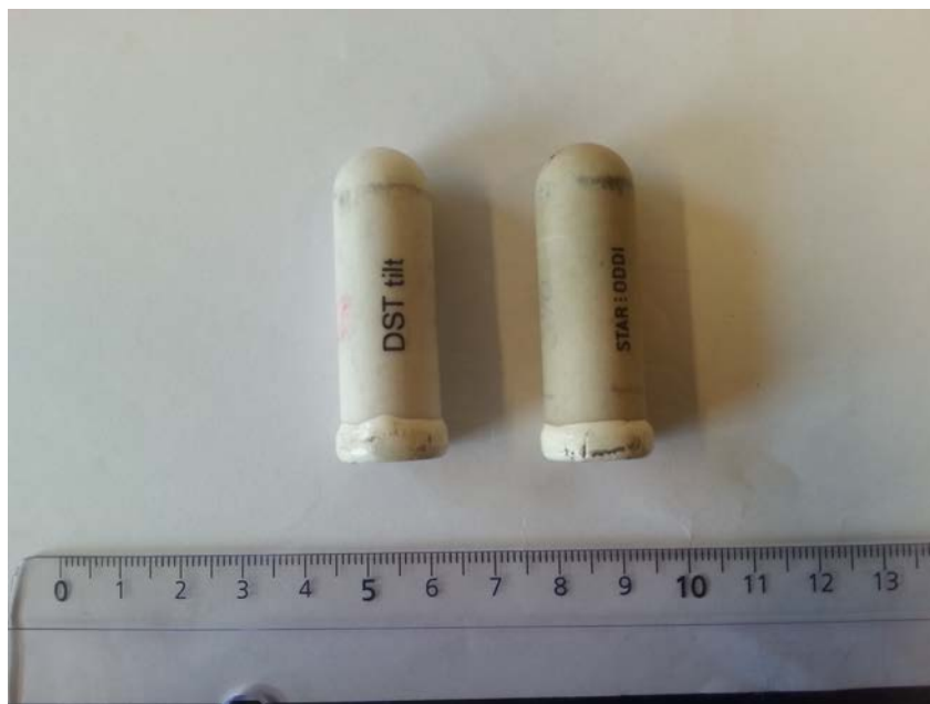
Figur 4. StarOddi selvregistrerende vinkelsensorer.
